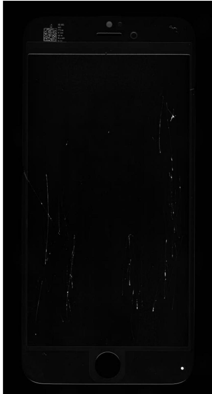
1. 以iPhone 6的手机玻璃为例，设备可以清晰地拍到手机玻璃上的划痕、坑与裂缝等缺陷，最小可拍到 $>10\mu\text{m}$ 的缺陷。
